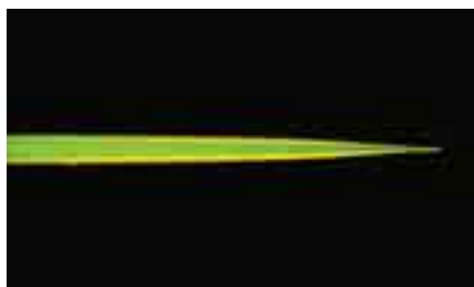
Microélectrode utilisée dans l'étude de messages proprioceptifs. Sa pointe mesure 1 µm.
