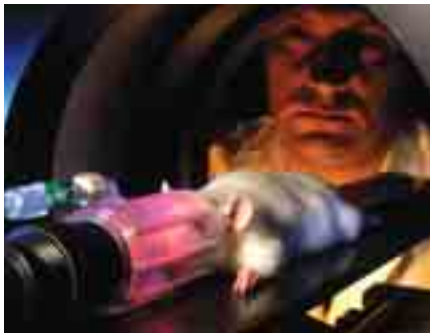
Plateforme d'imagerie à caméra micro-TEP qui permet d'obtenir des images fonctionnelles du cerveau du petit animal.
