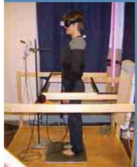
Dispositif d'analyse de la régulation posturale chez l'Homme, constitué d'une plateforme translationnelle pour l'étude des déplacements du centre de pression au sol, d'un masque de vidéonystagmographie pour celle des mouvements oculaires, et d'un système 2D d'analyse du mouvement pour étudier l'orientation du corps dans l'espace.
